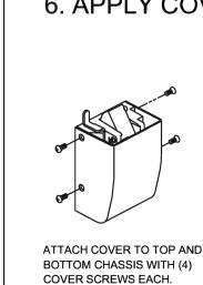
CHECK FINAL OPERATION OF DEVICE AND ADJUST, THEN FASTEN COVERS.
